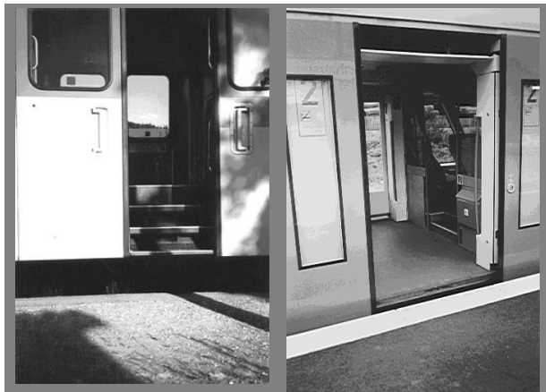
Derzeitiger Einstieg im Vergleich zum stufenlosen Einstieg eines modernen Fahrzeuges
