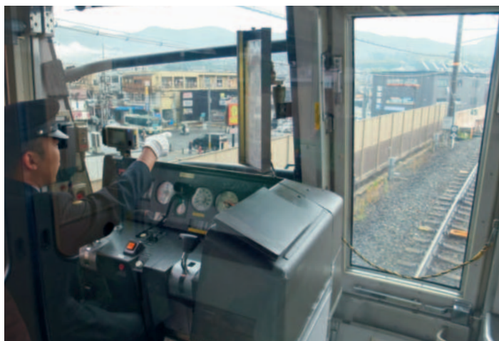
Der Lokomotivführer eines Nahverkehrszugs deutet im November 2013 zwischen Kyōto und Nara auf ein Aussensignal, das Fahrt zeigt (Foto: D. Sommerer).
